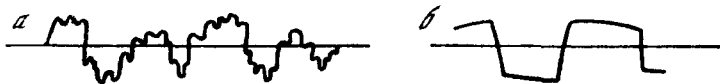
Рис. 4.1. Пульсации скорости при наличии мелкомасштабных флуктуаций, но без переменяемости ( a ) и с переменяемостью ( б )
